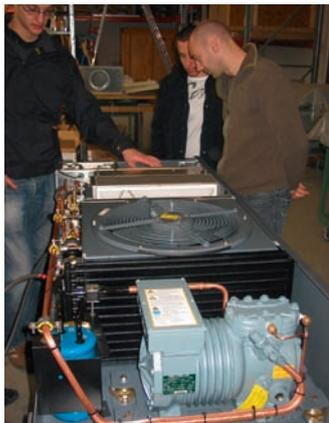
Ein Bahnklimagerät mit pumpengeschmiertem DKLP-Verdichter für Dachaufbau
