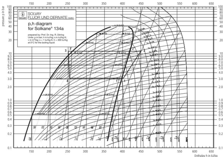
Abbildung 5: Mollier lg p-h Diagramm eines einstufigen Kaltdampfprozesses für Solkane 134a.
