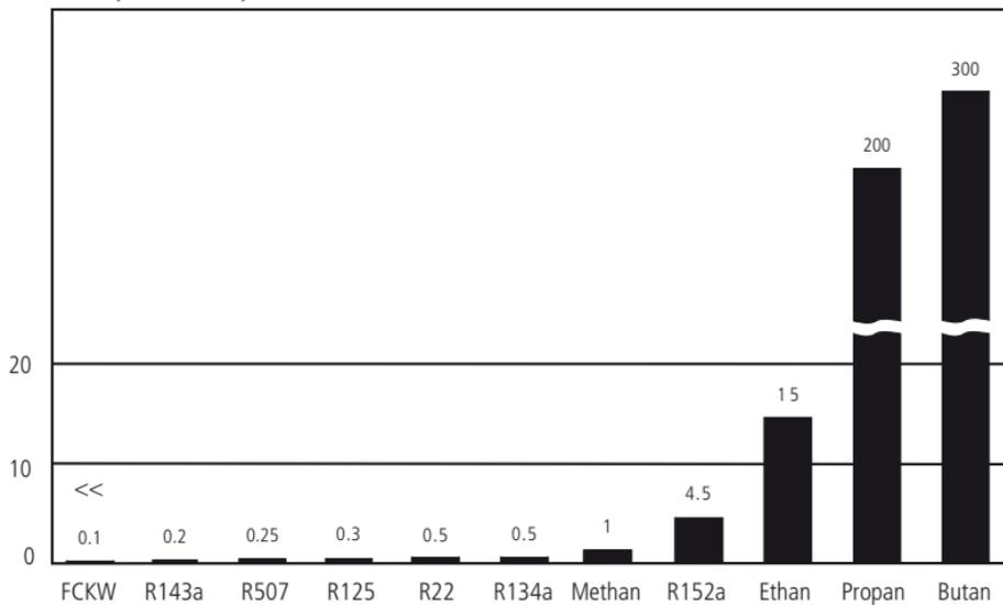
Abbildung 7: POCP-Werte verschiedener Kältemittel
