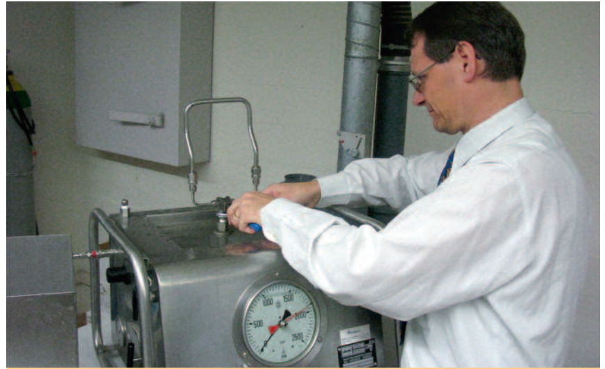
Peter Sennrich bei der Druckprüfung der Übungsstücke bei mehr als 1250 bar!
